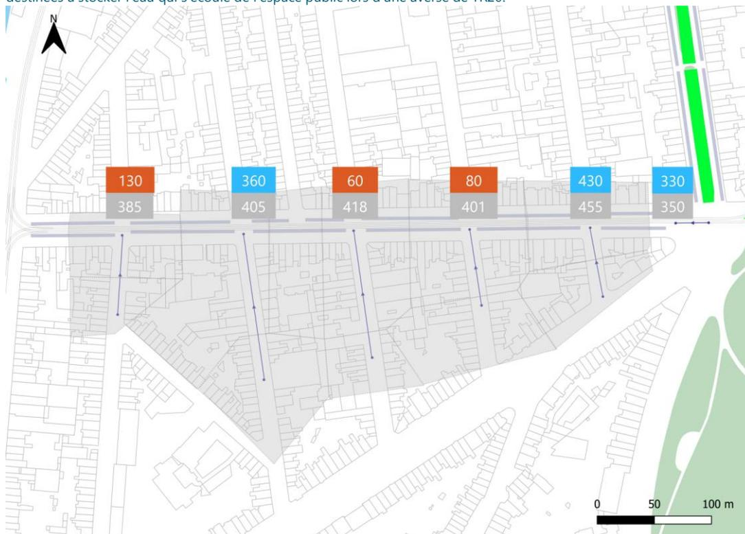
La conception du réseau de conduites d'acheminement doit permettre une utilisation optimale du volume des caisses de stockage. Néanmoins, à certains endroits, le volume d'eau est supérieur à la capacité de temporisation. Ce volume d'eau excédentaire pourrait être réparti entre des zones tampons en aval en créant des raccords. Cette possibilité doit être examinée ultérieurement, par exemple durant l'élaboration du plan directeur.
