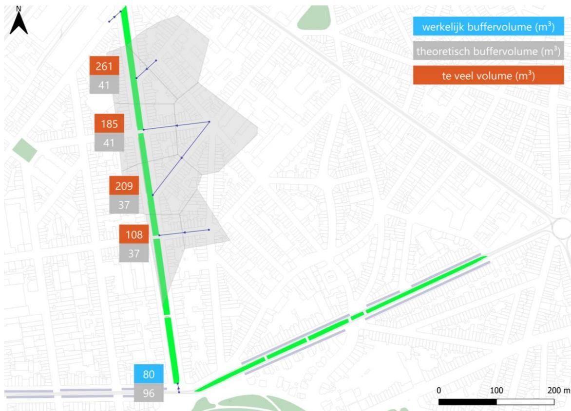
Dans le scénario « noue étroite », les noues n'ont pas une capacité suffisante pour stocker l'eau acheminée, même si le réseau de conduites d'acheminement est fortement réduit.
