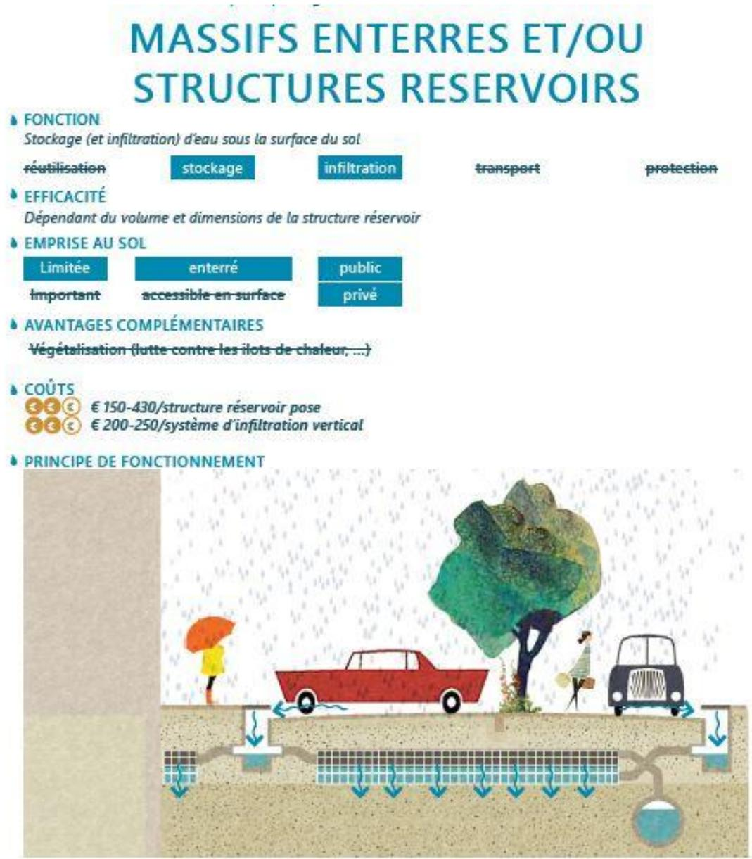
Le tamponnage souterrain est réalisé au moyen de « caisses à eau » ou de puits. Si le sol le permet, il peut également permettre l'infiltration. Les essais d'infiltration effectués sur les grandes avenues ont montré que le sol est moyennement à bien perméable. Dans la section 6.2.6, l'aménagement de massifs enterrés dans le périmètre du projet est décrit plus en détail.
