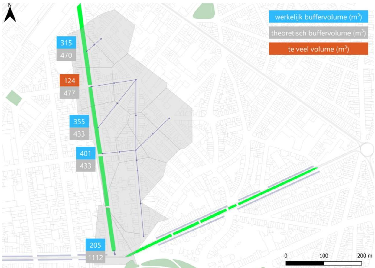
Dans les scénarios « noue étroite avec massif enterré » et « noue élargie », quatre noues tampons sur cinq sont remplies sans que le volume tampon maximal ne soit dépassé. Dans les deux scénarios, seule la capacité de stockage d'une seule noue est dépassée. Cela pourrait être résolu en raccordant cette noue à la noue en aval de sorte que l'eau soit répartie entre les deux tampons. Les détails de cet aménagement doivent être vérifiés dans le cadre d'une étude détaillée.
