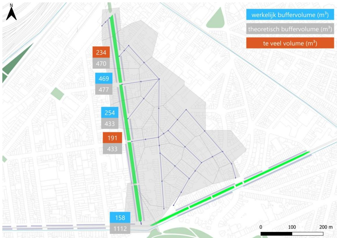
Dans les deux scénarios, le volume tampon maximal est dépassé dans deux nœuds tampons sur cinq ; les autres nœuds conservent une partie de leur capacité de temporisation. Le volume excédentaire dans le nœud le plus en aval devra s'écouler vers la Senne, mais le manque de capacité de temporisation dans le deuxième nœud le plus en amont peut être compensé par la création d'un débit vers la zone tampon suivante. Cela doit être détaillé dans une étape ultérieure.
