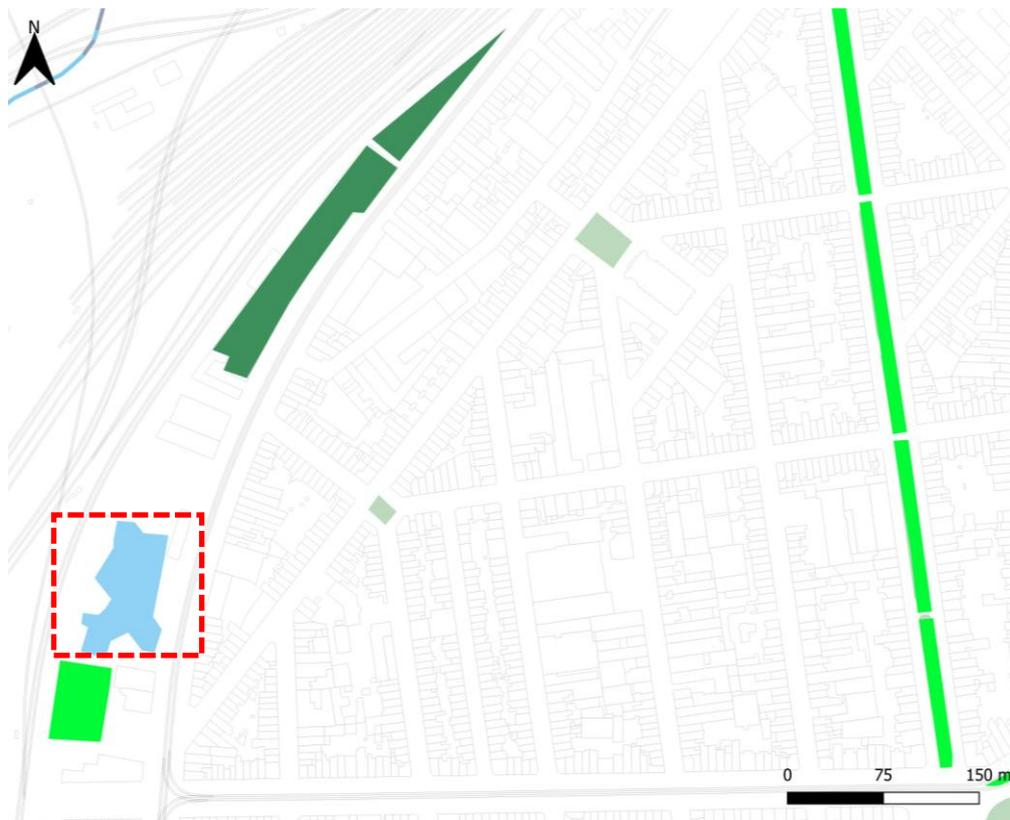
Le bassin a encore une grande capacité de stockage. Si un espace de stockage d'eau supplémentaire de 1,5 m de hauteur était ménagé dans le Marais, un volume de stockage théorique maximal de 11 000 m<sup>3</sup> pourrait être obtenu.
