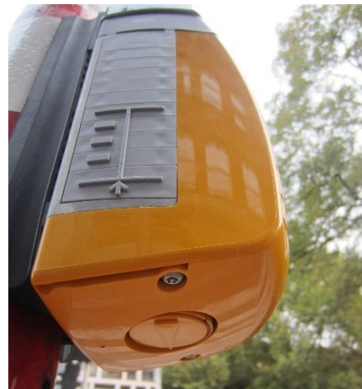
Plan schématique de la traversée et flèche en relief, sous le boîtier, indiquant le sens de la traversée
