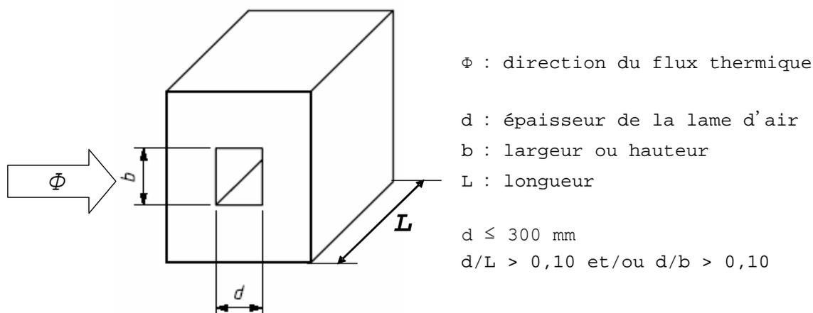
Dans l'annexe B.4 de la NBN EN ISO 6946, on trouve le calcul de la résistance thermique de petites lames d'air tubulaires non ventilées (creux, vides). Dans le cas de ces lames d'air, le rapport entre l'épaisseur et la longueur (ou largeur) est supérieur à 0,1. La Figure [2] : Creux tubulaires illustre une telle lame d'air.
