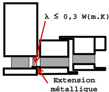
Montage du profilé sur la traverse par usage d'une extension du profilé aluminium extérieur. Matériau de remplissage à faible conductivité thermique ( $\lambda \leq 0,3 \text{ W/(m.K)}$ )
