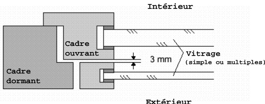
La valeur  $U_w$  d'une fenêtre à vantaux dédoublés constituée d'un cadre dormant et de deux ouvrants séparés (avec vitrages) et parallèles (voir Figure [17] : Illustration d'une fenêtre à vantaux dédoublés), peut être calculée selon l'Eq. 19, mais dans laquelle la valeur combinée  $U_g$  des deux vitrages est calculée suivant :
