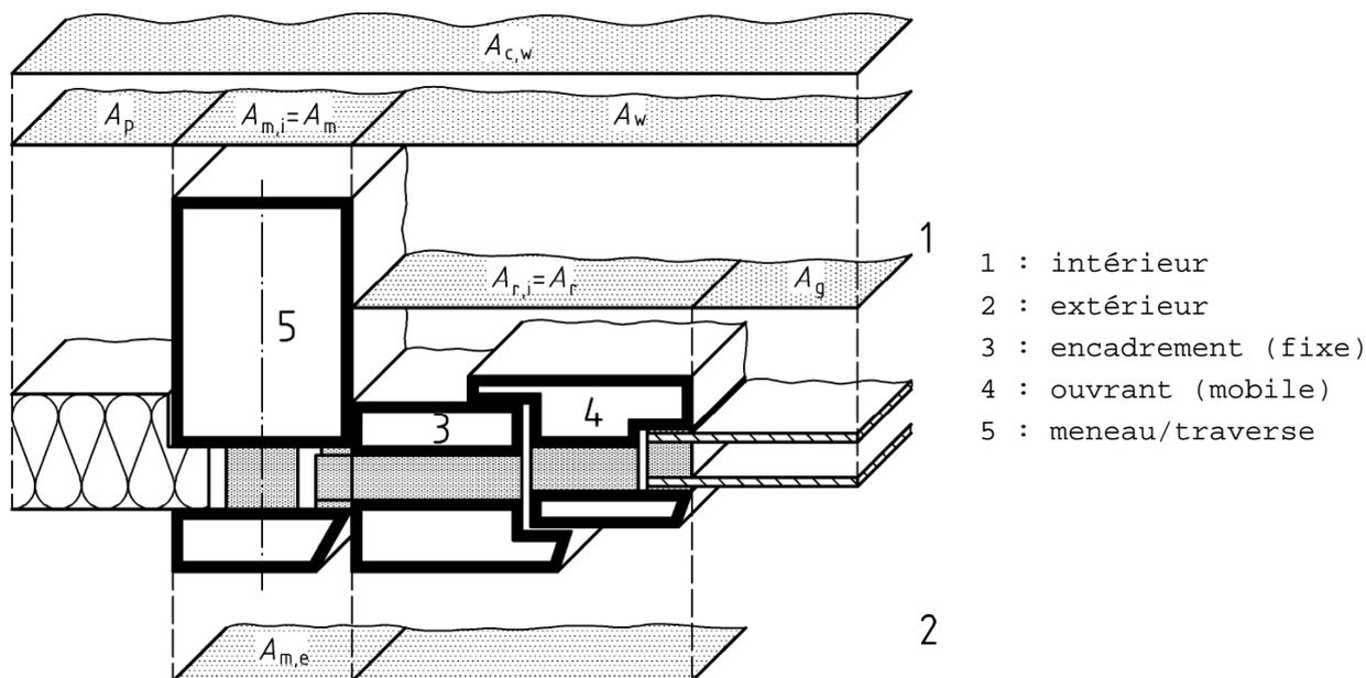
Le coefficient de transmission thermique d'un module d'une façade légère ( $U_{cw}$ ) est calculé suivant :
