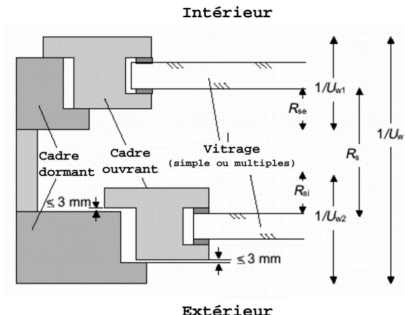
La valeur  $U_w$  d'une double fenêtre, c.-à-d. un système où deux fenêtres séparées sont placées parallèlement dans une même ouverture de jour (voir Figure [16] : Illustration d'une double fenêtre), est calculée de la manière suivante :
