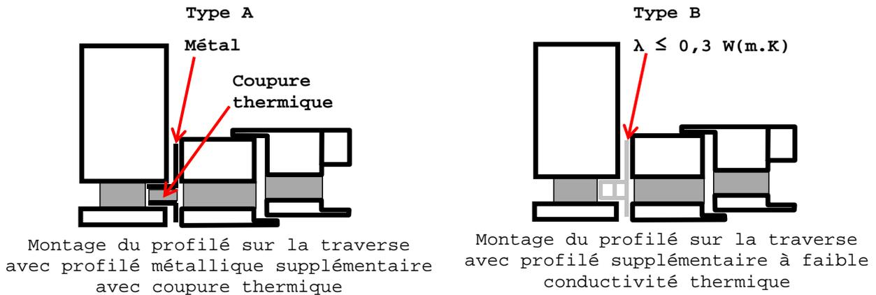
**Figure [41] : Jonction profilé-traverse : Types C1 et C2**
