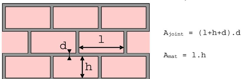
Pour d'autres configurations géométriques, (par exemple pas de joints de boutisse), la proportion doit être calculée d'une manière appropriée, et doit être introduite dans l'Eq. 88.
