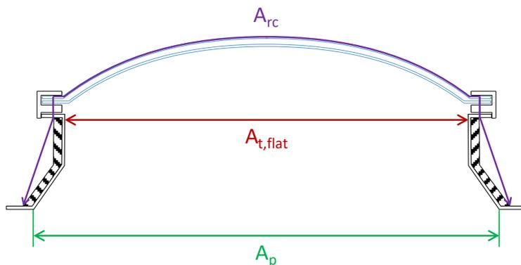
La Figure [51] reprend la définition de la surface projetée du lanterneau  $A_p$  ainsi que celles de la surface de la projection horizontale de la surface extérieure éclairante  $A_{t,flat}$  et de la surface d'un lanterneau avec costière  $A_{rc}$ . Pour les surfaces  $A_{t,flat}$  et  $A_{rc}$ , la Figure [51] n'est qu'un schéma de principe : les définitions exactes sont données par la norme NBN EN 1873.
