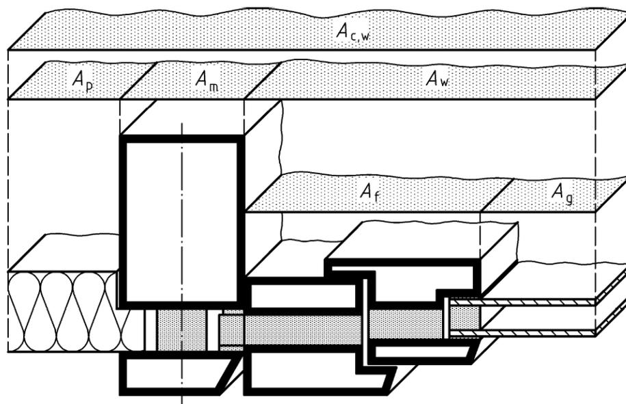
Si le périmètre d'un vitrage,  $l_g$ , ou d'un panneau opaque,  $l_p$ , est différent de chaque côté, le périmètre est défini par l'interface entre la surface (cf. ci-dessus) du vitrage et de l'encadrement (voir Figure [24] : Schéma de la surface vitrée et du périmètre (1 : verre)).
