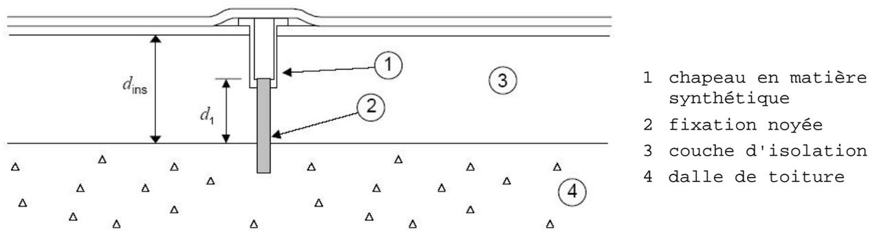
Pour les autres cas, la méthode de calcul approchée suivante peut être appliquée. L'impact de la fixation mécanique y est déterminé par le terme correctif  $\Delta U_f$  calculé comme suit :
