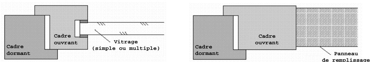
Le coefficient de transmission thermique d'une fenêtre ( $U_w$ ) ou d'une porte ( $U_D$ ) ayant des dimensions connues et pourvue de parties vitrées et/ou de panneaux de remplissages opaques et/ou de grilles de ventilation, est généralement calculé au moyen de la formule suivante :
