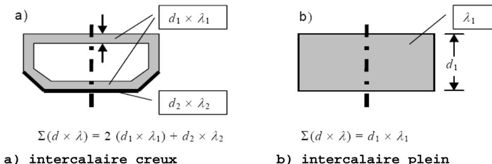
Le tableau E.1 donne des valeurs par défaut  $\Psi_g$  pour des intercalaires normaux et thermiquement améliorés en fonction du coefficient de transmission thermique du vitrage et du profilé. Alternativement, on peut aussi utiliser les valeurs du tableau E.2.
