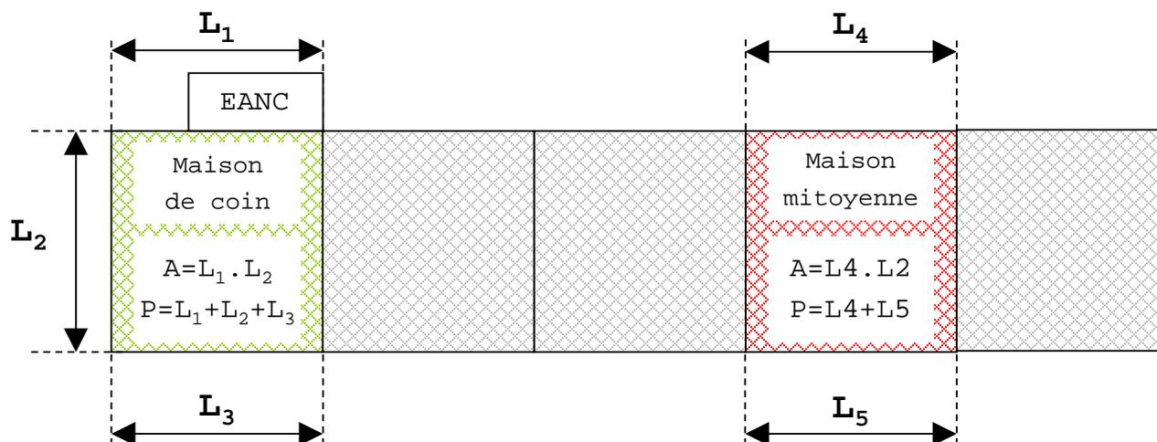
Le concept d' "épaisseur équivalente" ( $d_t$  pour les planchers et  $d_g$  et  $d_w$  pour les murs enterrés) est un concept arithmétique qui a été instauré pour simplifier l'écriture des différentes formules pour la valeur U.
