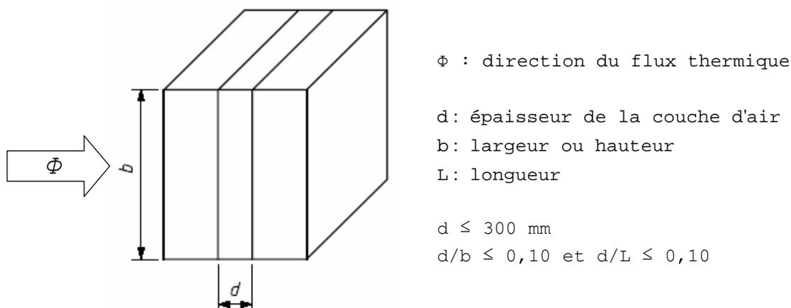
Pour les couches d'air entre une ou plusieurs surfaces à basse émissivité (réfléchissantes) il faut se référer aux annexes B.2 et B.3 de la NBN EN ISO 6946. La valeur de  $h_{r0}$  correspondant à une température de 10°C est considérée et la valeur de  $h_a$  est prise dans le Tableau B.1 de cette norme. Les définitions de  $h_{r0}$  et  $h_a$  sont données dans cette même norme.
