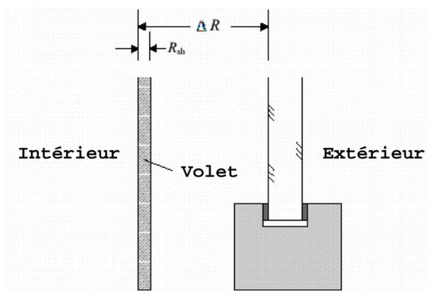
La résistance thermique supplémentaire est comptabilisée lors du calcul du niveau K et du niveau E selon les règles décrites au § 7.7.2 de l'annexe PER. Pour l'évaluation de l'exigence  $U_{max}$  suivant l'annexe U/R, la résistance supplémentaire n'est pas considérée.
