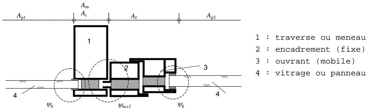
**10.5 Détermination de la valeur  $U_{cw}$  pour une façade légère composée de différents modules**
