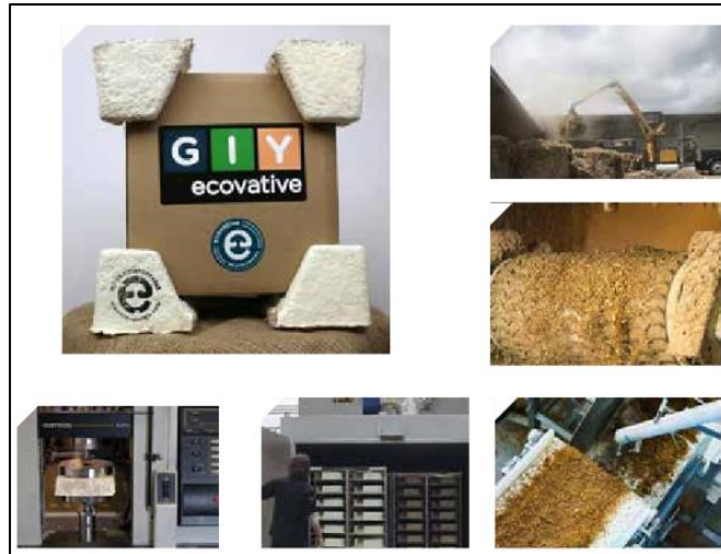
Afb. 12: Mycofoam, een alternatief voor polystyreen voor de levering van breekbare producten. Bron: Rapport van het VN-Milieuprogramma
