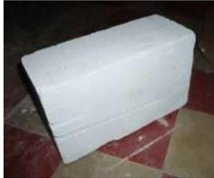
Figure 8 – Bloc de béton cellulaire
