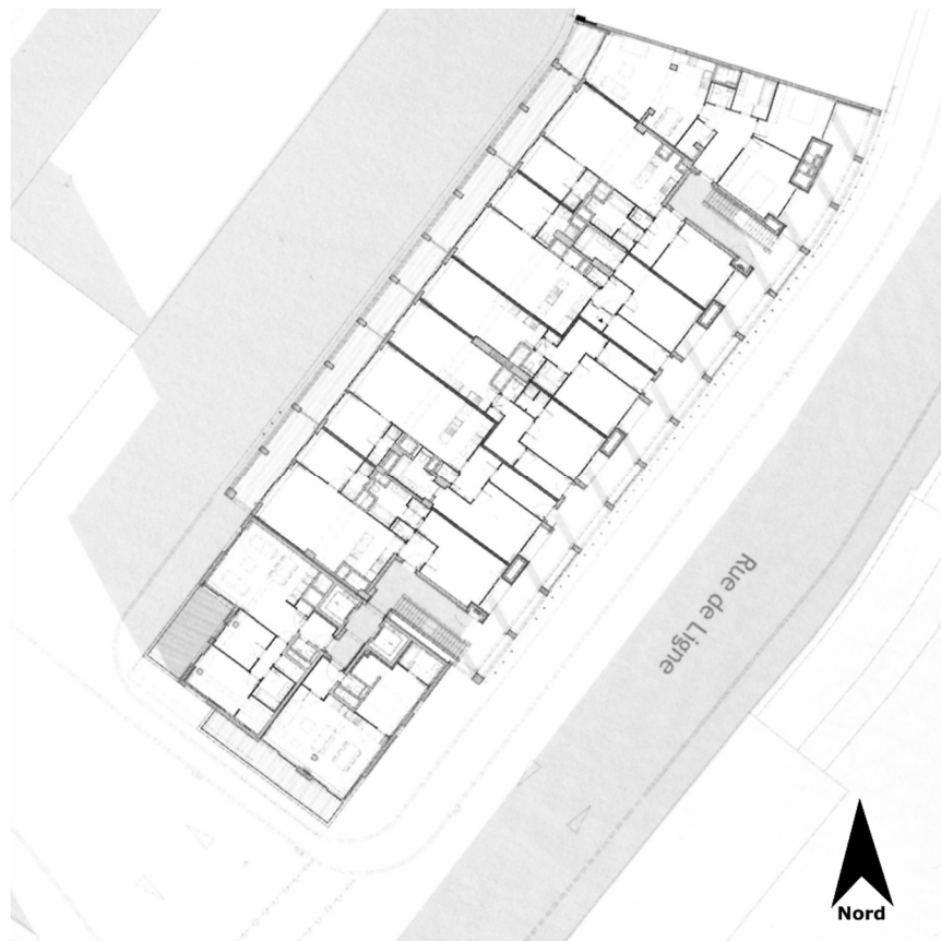
Figure 3 : Cité administrative – le bâtiment étant trop profond pour du logement, on a prévu de « creuser » les plateaux avec une coursive côté rue de Ligne et des balcons individuels qui respectent le rythme de la façade ouest – source : Archi 2000
