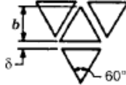
Figuur [2]: Schematische voorstelling van de kanalen voor een regenerator met gebogen platen
