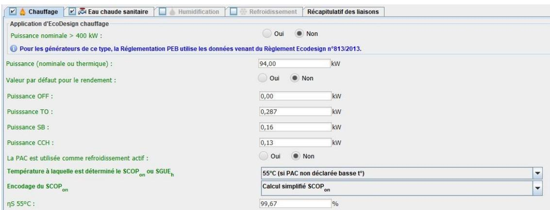
La combinaison chaudière à condensation + booster s'encode de la manière suivante :
