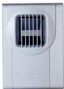
Bouche d'extraction hygroréglable : l'ouverture est modifiée au moyen d'une tresse qui se dilate ou se contracte avec l'humidité
