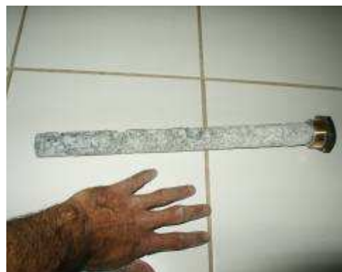
Photos 16 et 17 : Anode au Magnésium neuve à gauche et entamée à droite (mais encore fonctionnelle)
