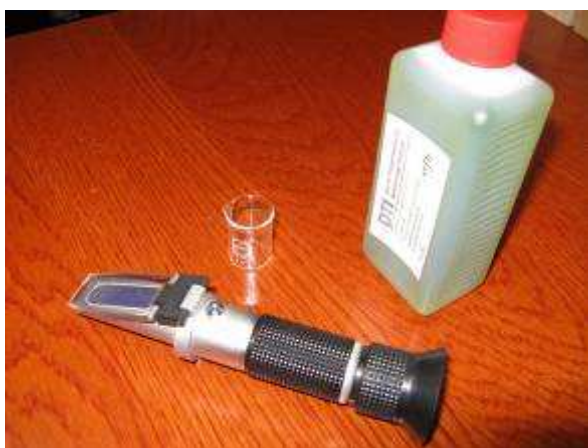
Foto 13 : Met de refractometer kan het antivriesgehalte worden gemeten
