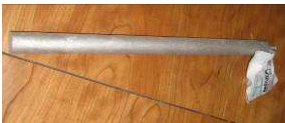
Foto's 16 en 17 : Magnesiumanodes: een nieuwe anode (links) en een aangetaste (maar nog steeds functionele) anode (rechts)
