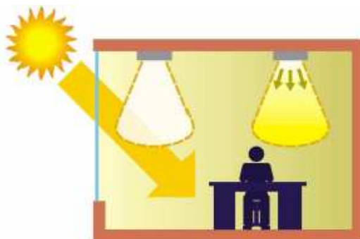
Principe du zonage en fonction des disponibilités d'éclairage naturel (Source : Architecture et Climat).
