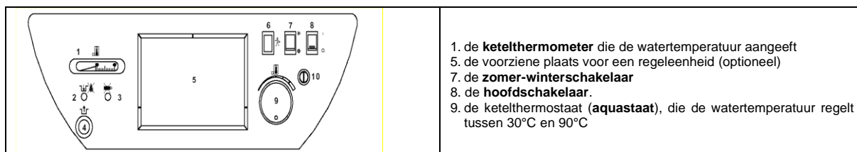
Afbeelding 37 – Generiek controlepaneel van een verwarmingsketel
