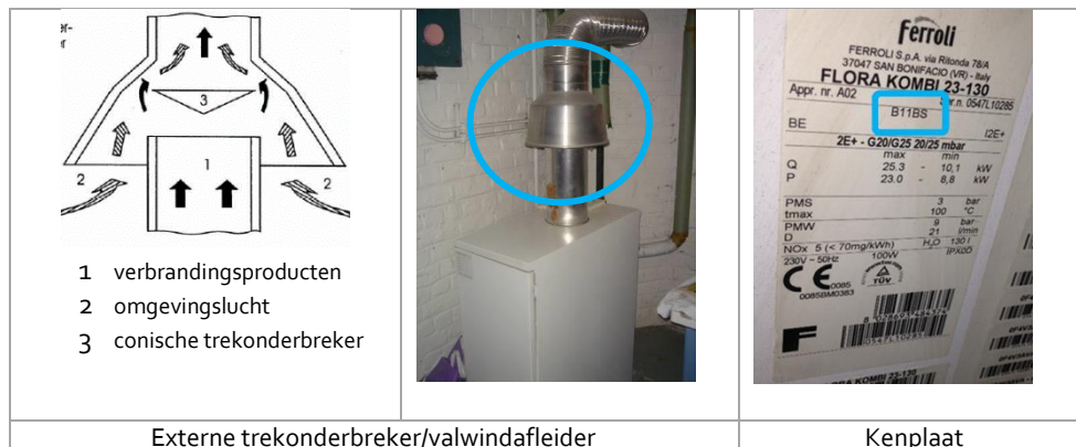
Afbeelding 15 – Externe trekonderbreker/valwindafleider
