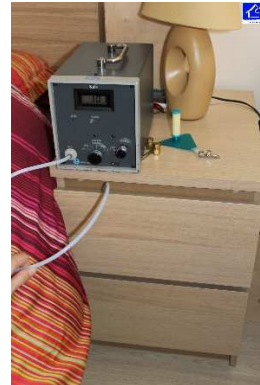
Foto 2: Interscan-apparaat voor het meten van formaldehyde (Bron: RCIB)
