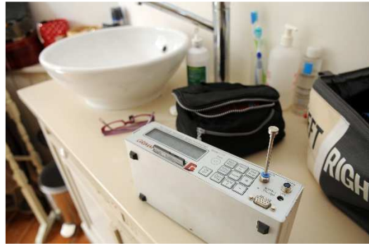
Foto 4: apparaat voor het meten van fijne deeltjes (Bron: RCIB)
