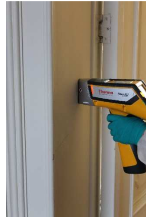
Foto 3: Draagbare NITON-apparaat voor loodmeting (Bron: RCIB)
