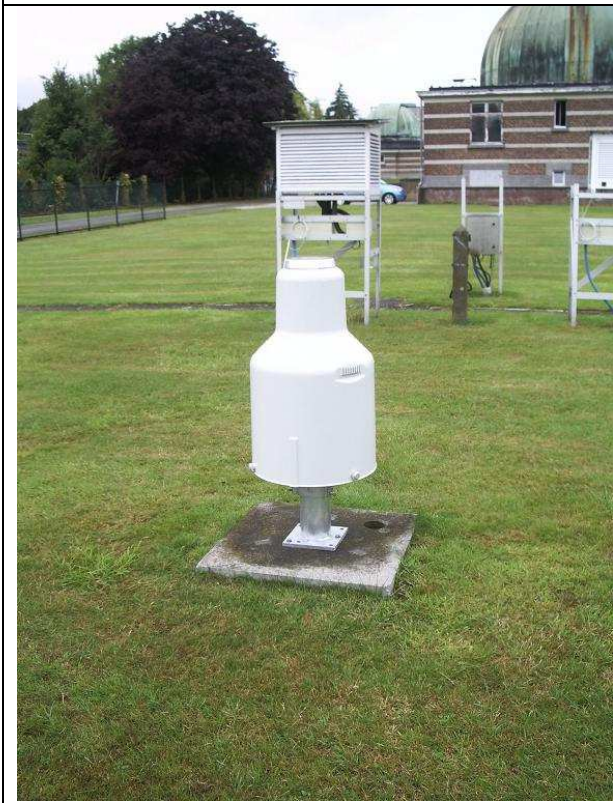
Figure 19 : Pluviomètres dans le parc synoptique : de gauche à droite et de bas en haut : le OT1sol (à pesée, similaire au OT1 mais sans cône de Nipher), le SYN (à pesée, avec cône de Nipher, similaire au OT1) et le OT2sol (à pesée, sans cône de Nipher, similaire au OT2).
