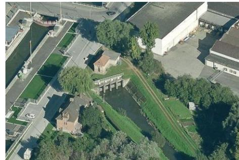
**Figure 21 :** Vue aérienne des vannes qui contrôlent l'écoulement de la Senne vers le Canal à hauteur du quai d'Aa (source : bingmap 2013)
