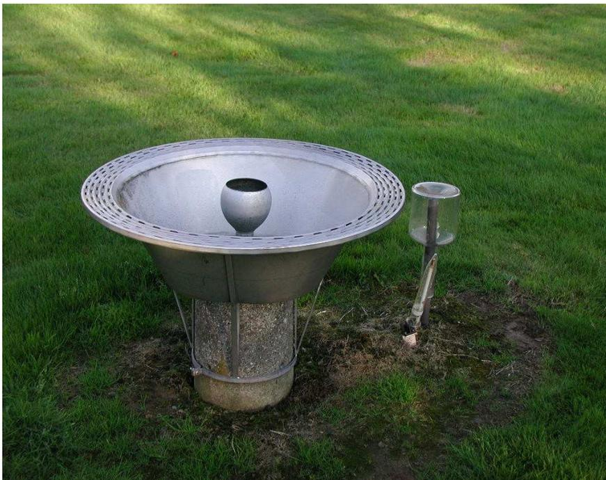
**Figure 1.1.2.1.** Le pluviomètre manuel P50 relevé chaque matin à Uccle pour connaître le cumul journalier des précipitations. La mesure de la quantité d'eau tombée est effectuée en vidant la bouteille dans une éprouvette finement graduée (mesure au dixième de mm ou  $l/m^2$ ). Par temps de neige, la bouteille et l'entonnoir sont remplacés par un nivomètre d'ouverture identique qui permet une meilleure récolte des flocons de neige.
