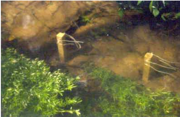
Paaltjes met daaraan het kunstmatige substraat (100% acrylwol) worden in Woluwe geplaatst voor 2 tot 4 weken.
