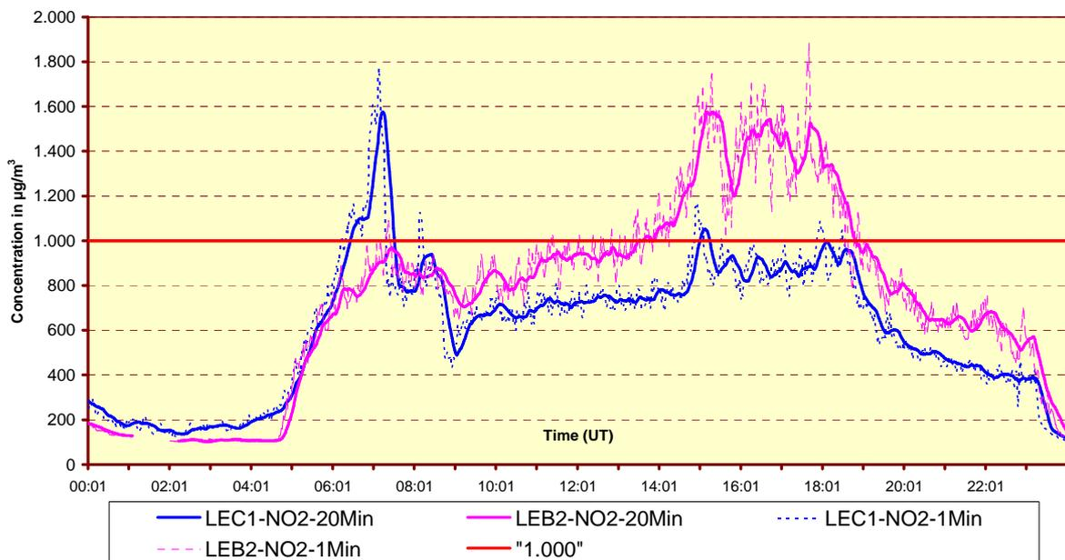
Fig. 4: NO<sub>2</sub> – évolution des valeurs minutes et de la moyenne glissante sur 20 minutes dans les deux postes de mesure du tunnel Léopold II
