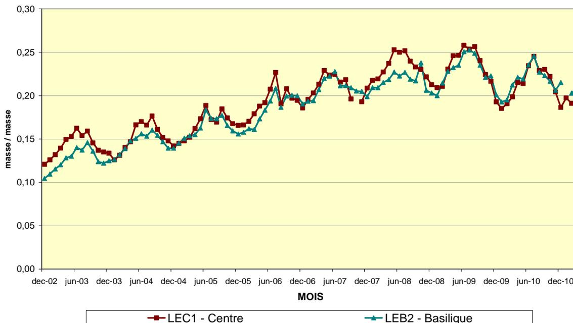
Fig. 11 : Évolution du rapport NO<sub>2</sub>/NO<sub>x</sub> dans les deux postes de mesure du tunnel Léopold II.
