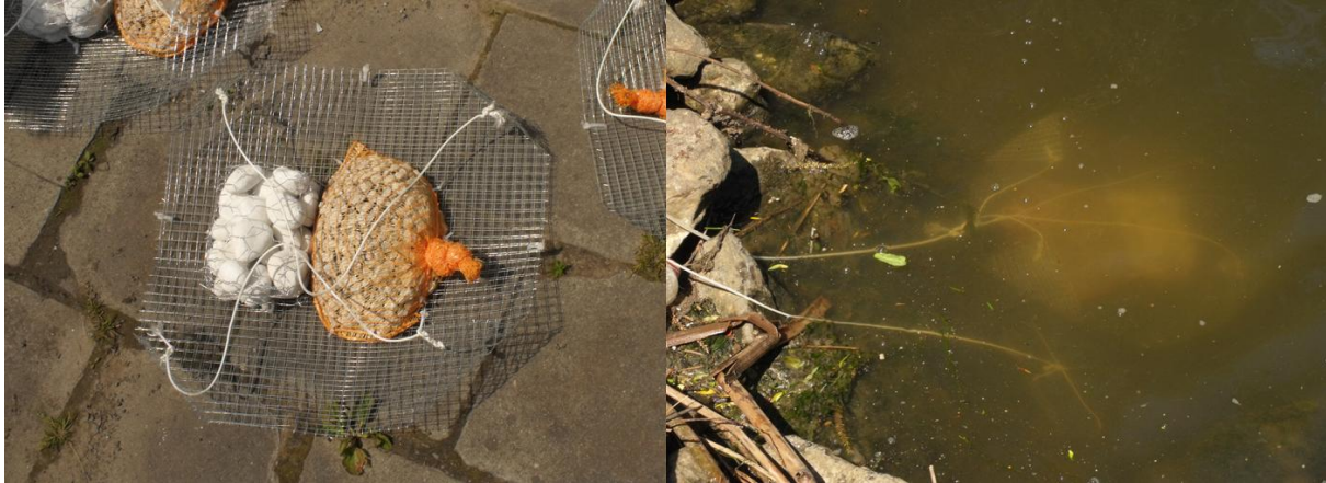
Figuur 5: Artificieel substraat voor inzameling van macro-invertebraten in Zenne, kanaal en vijvers. Links vóór installatie, rechts bevestigd aan de oever van Zenne (S4), in koppel met een tegel voor kolonisatie door diatomeeën.
