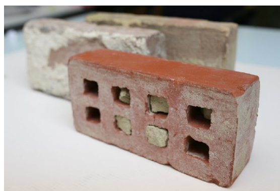
Brique de réemploi "moderne", avec des perforations.
