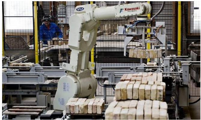
Processus de nettoyage et de conditionnement des briques partiellement automatisé : l'entreprise danoise Gamle Mursten (photo : Katrine Damkjær, www.fyens.dk).
